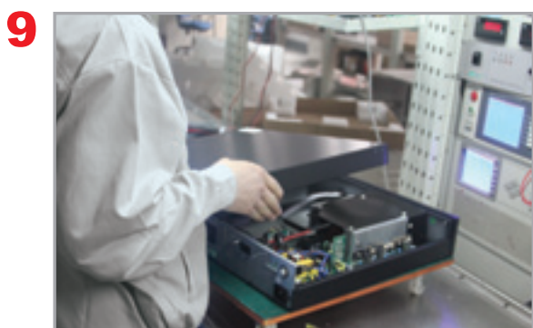
Intégration des cartes électroniques et des batteries dans les racks 19".
