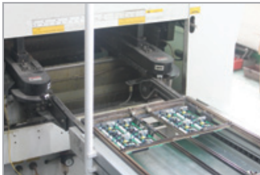
Soudure à la vague des composants électroniques traversants (axiaux et radiaux) et des CMS.
