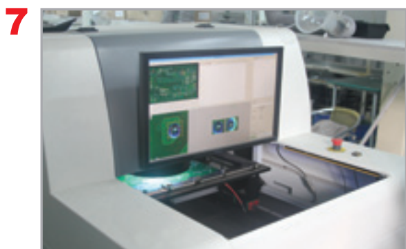
Contrôle automatique des soudures et correction manuelle des éventuels défauts.
