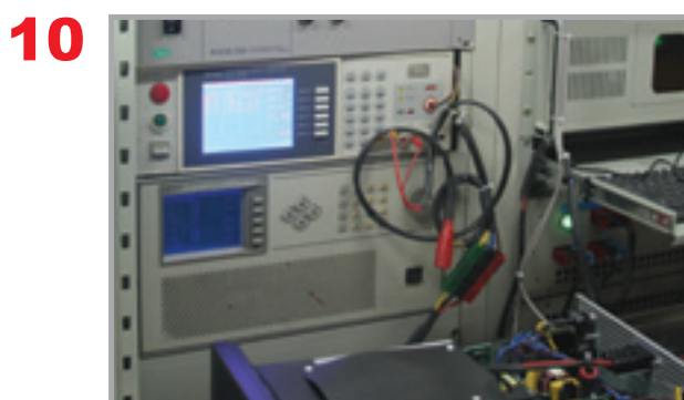
Test fonctionnel des onduleurs.
