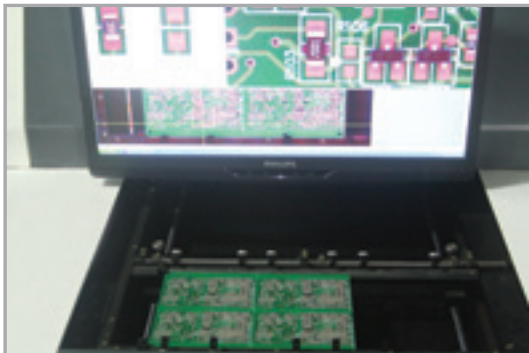
Test automatique par caméra de présence de la qualité de pose des composants CMS.
