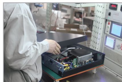
Intégration des cartes électroniques et des batteries dans les racks 19".
