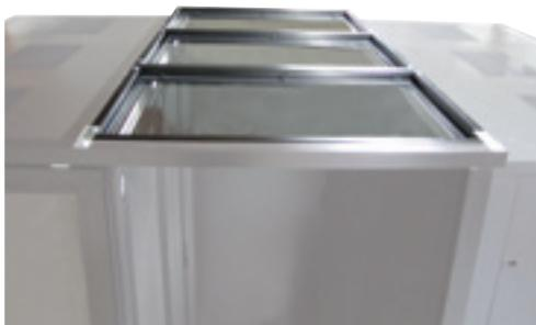
Les toits pour couloirs de baies sont des éléments de la solution de refroidissement COLDRACK Platine Réseaux disponibles en largeur 600 ou 800. Peinture laquée noire qualité Qualicoat. Matériaux : chassis aluminium couleur RAL9005 et plexiglass 5mm incolore.
