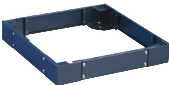
Ces plinthes permettent de réhausser la baie de 100mm. Matériau : acier laminé à froid d'épaisseur 1,2mm. Couleur : noir. Produits compatibles avec la référence : 71359.
