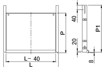
Tablettes clavier télescopiques pour baie 19". Matériau : acier laminé à froid d'épaisseur 1,2mm. Section rail coulissant : 14". Longueur de flexion 210mm. Charge admissible : 20kg. Couleur : noir.
