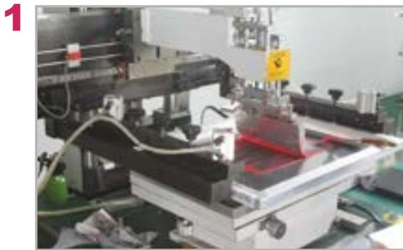
Sérigraphie de colle avant la pose automatique des composants CMS (Composants Montés en Surface).
