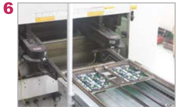
Soudure à la vague des composants électroniques traversants (axiaux et radiaux) et des CMS.
