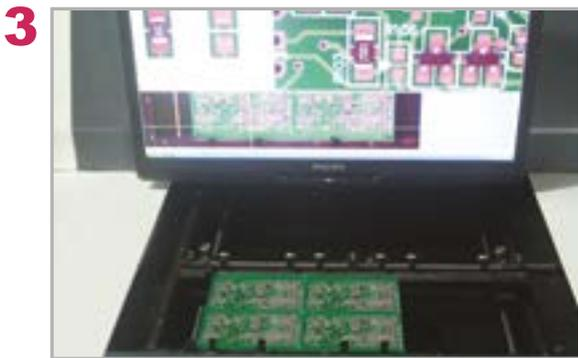
Test automatique par caméra de présence de la qualité de pose des composants CMS.
