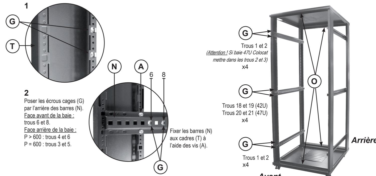
Fixer les plaques (O)x 4 sur les ouvertures passe câbles avec les vis (E)x 8.
