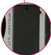
Slot Multifonctions pour cartes SNMP.
